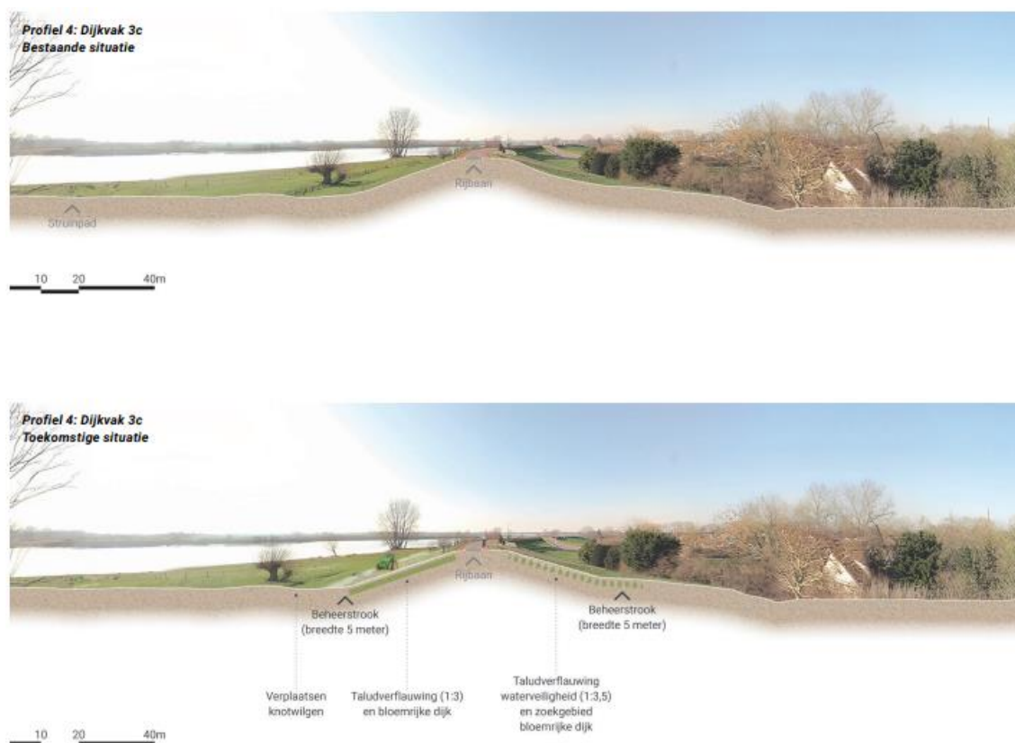
Figuur 3.5 Impressie inpassing (profiel) dijkvak 3c
