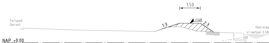
Figuur 16: ontwerpdoorsnede van de waterkering langs de oever (zie doorsnede F in figuur 15).
