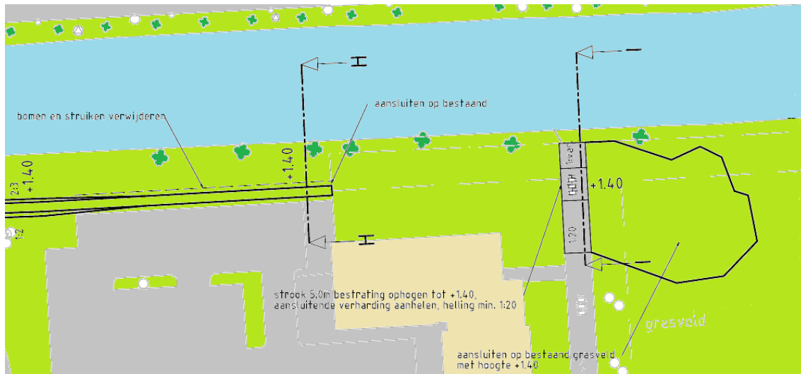
Figuur 18: voorkeursontwerp bij het bedrijventerrein. In zwarte lijnen de ophoging van de waterkering.
