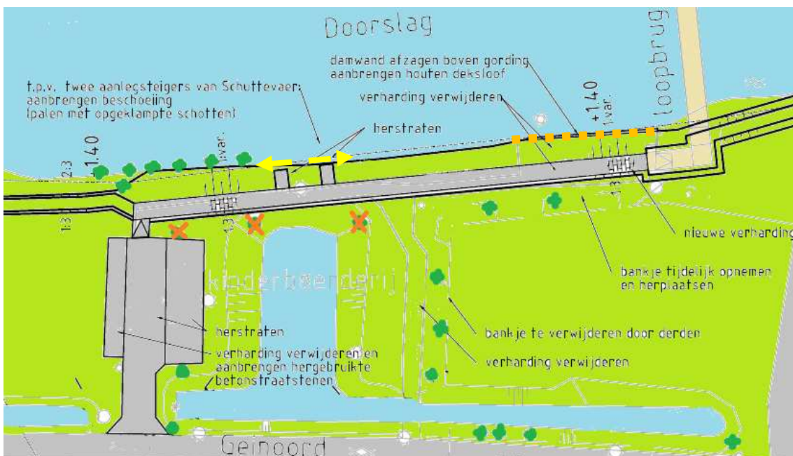
Figuur 11: ontwerp bij de loswal, inclusief aanpassingen aan de bestrating. De ophoging en de nieuwe positie van de bestrating zijn met zwarte lijnen aangegeven. In rood de te verwijderen bomen. In geel de aan te brengen beschoeiing. In oranje de loswal.
