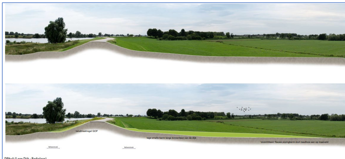
DP9+0 (Lage Dijk - Radiolaan) Figuur 3-4 Aanzicht dijkvak Lage Dijk - Radiolaan in de huidige situatie (boven) en de nieuwe situatie (onder)
